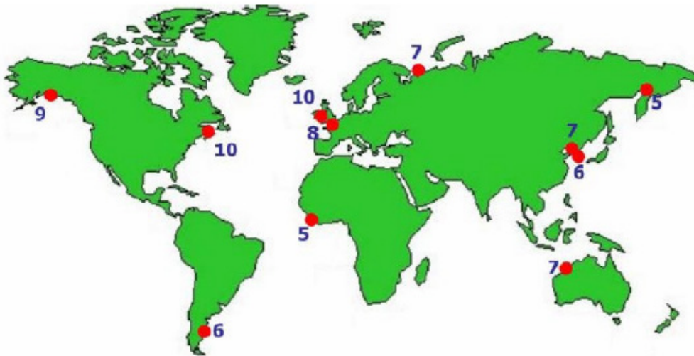
Abb.5 (S.94) - Tidenhub in Metern. Ein ausreichender Tidenhub ist Voraussetzung für die Nutzung von Ozean-Energie durch Gezeitenkraftwerke.
