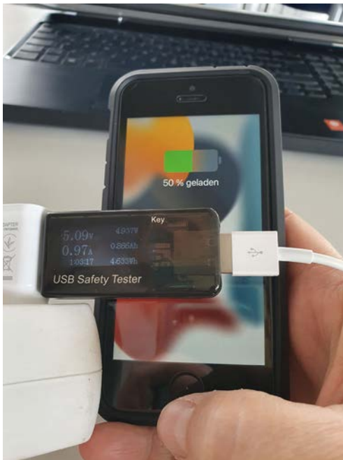
Foto 9: Funktionstest eines Handyakkus © UniLab Adlershof
