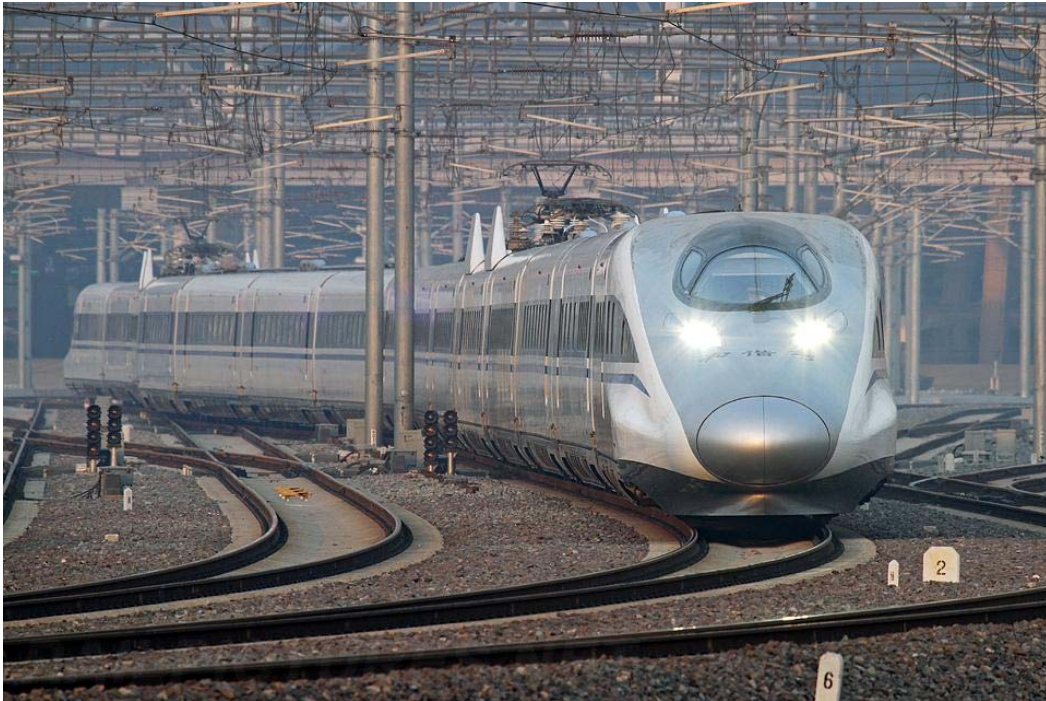
Abb. 3: Der chinesische CRH380AL, eine „Kreuzung“ des deutschen Velaro (ICE3) mit dem japanischen E2 Shinkansen, kann eine Höchstgeschwindigkeit von bis zu 380 km/h erreichen und ist damit der derzeit schnellste Serienzug der Welt. Aus wirtschaftlichen Gründen wird diese Geschwindigkeit jedoch selbst in China nicht ausgefahren. (Foto: Jwjy9597, Wikimedia Commons)
